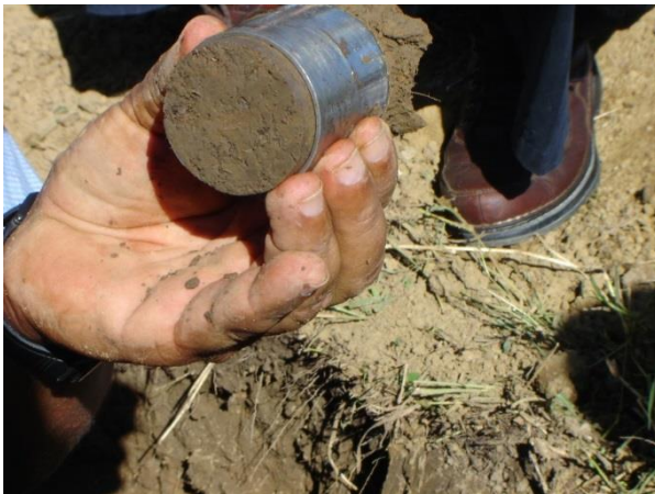
Anexo 3. Cilindro metálico para densidad aparente y porosidad.
