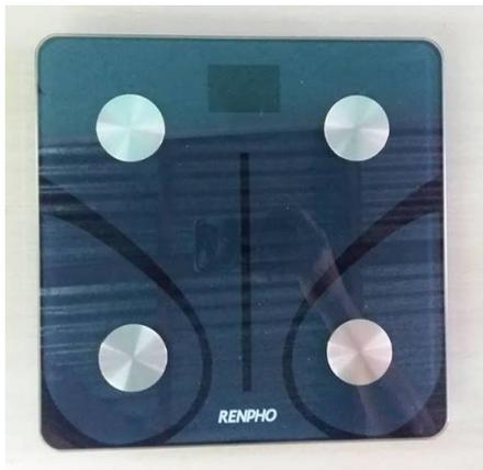
Báscula inteligente para medir composición corporal a través de bioimpedancia eléctrica (bipolar)
