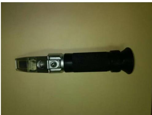
Refractómetro utilizado para medir la GEO
