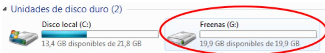
Figura 198: Disco iSCSI detectado como medio de almacenamiento en máquina anfitrión
