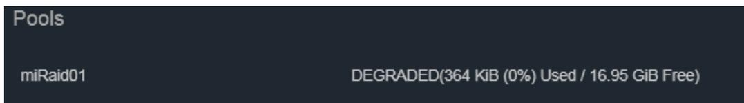
Figura 241: RAID en estado degradado luego de la eliminación del disco 3
