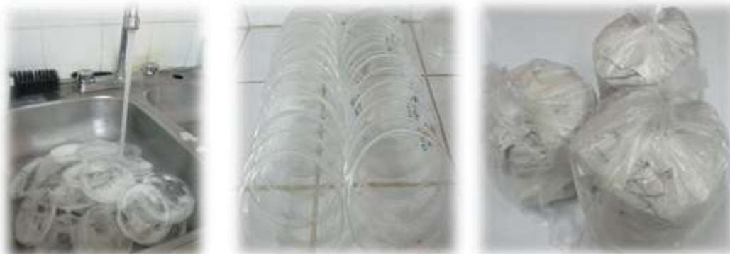
**Fig. 2:** Lavado de platos petric, secado, sellado con papelografo y colocados en bolsas plasticas para su posterior esterilizacion en la autoclave(olla de presion).
