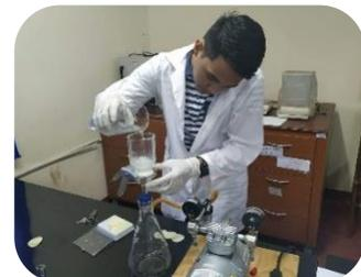
proceso de filtración con un poro de 45micras.
