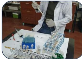
extracción de 5ml de AR para medición de nitrato, amonio y fosforo.
