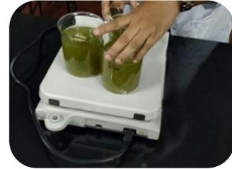
aceleración de proceso floculante en plancha agitadora.
