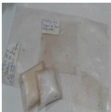
FIGURA 8: Elaboración de sachetz como alternativas al empaçado alimentario elaborados a partir de almidones termoplásticos.
