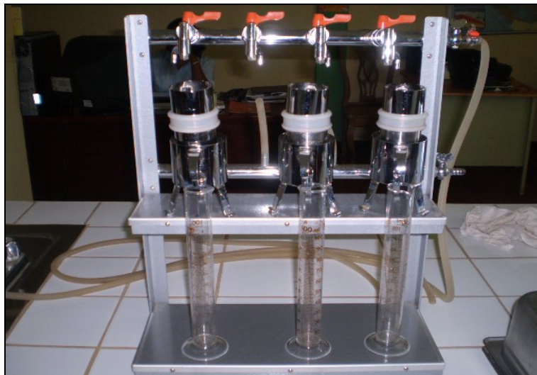
Realización de la medición del coeficiente de permeabilidad mediante el Instrumento DAIKI modelo 4000.
