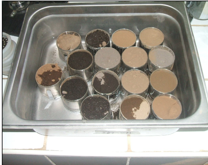
Muestras de suelo en proceso de saturación durante una hora.
