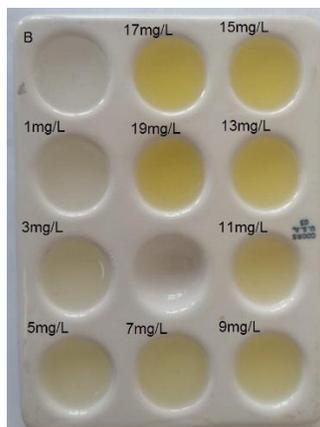
Figura 13 disoluciones estándar de fosforo en un rango de 1ppm a 19ppm
