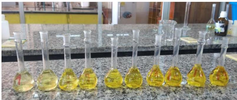
Figura 12 disoluciones estándar' de fosforo en un rango de 1ppm a 19ppm de derecha a izquierda respectivamente
