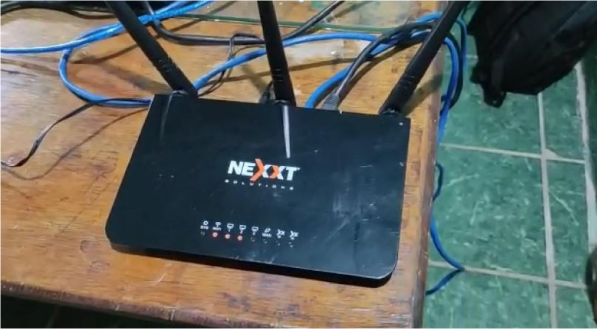
El modem Nexxt tiene la funcionalidad de switch que conecta al servidor Linux con la placa Arduino y así permite el flujo de información.
