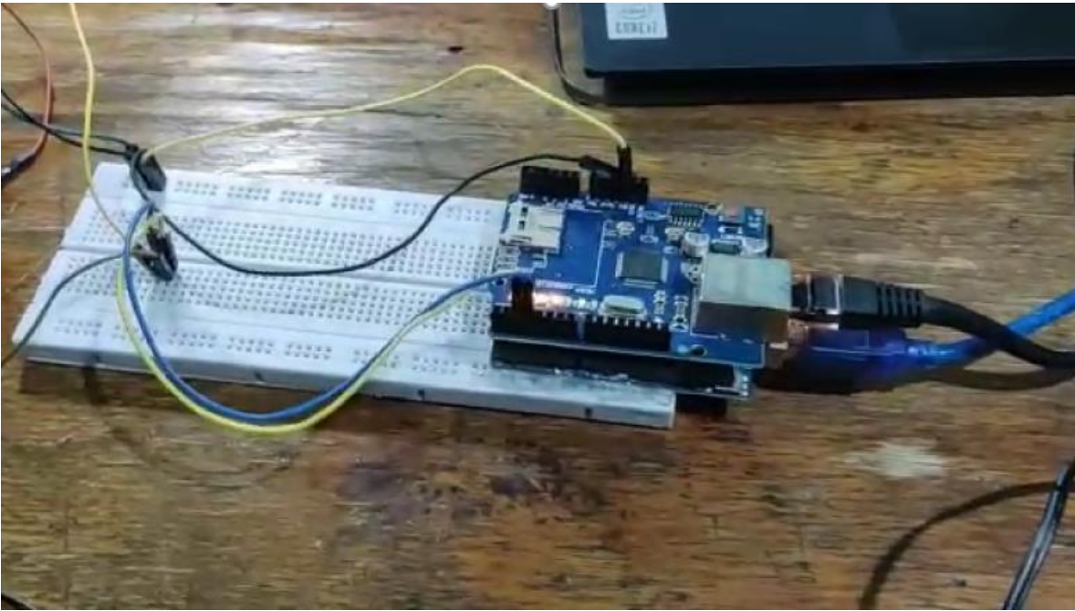
La placa Arduino conectada al sensor ultrasonico.
