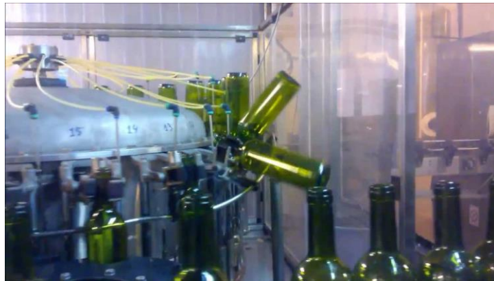
Figura 6: Máquina embotelladora, su actividad puede medirse con un tiempo de consumo igual a la cantidad de líquido suministrada a cada botella en un período de tiempo.
