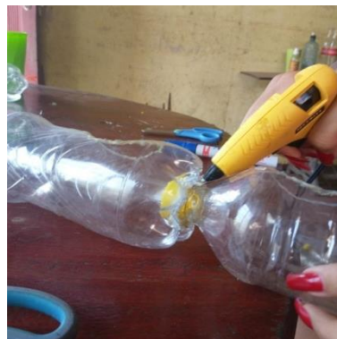
Figura 13. Unión de botellas (elaboración de tuberías recicladas)
