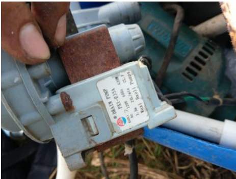
Figura 10. Bomba de agua reciclada.
