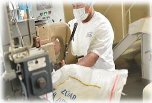
El azúcar después de pasar por la secadora se pasa a las tolvas de almacenamiento para luego ser envasada en sacos de 50 kg, o en bolsas de 2 kilos. La máquina realiza el llenado y sellado de las bolsas, El operario vigila el funcionamiento de la máquina, así como
