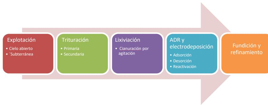
**Figura 1. Pasos del proceso de extracción del oro en la empresa minera (Elaboración propia).**
