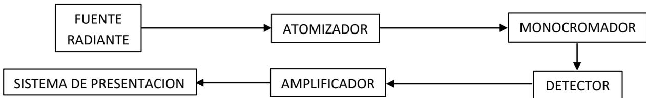
La fuente radiante más común para las mediciones de absorción atómica es la lámpara de cátodo hueco, que consiste en un cilindro relleno con un gas inerte dentro del cual se encuentra un cátodo (construido del metal a analizar) y un ánodo. Al aplicar un cierto potencial a través de los electrodos esta fuente emite el espectro atómico del metal del cual está construido el cátodo. (Blago Razmilic, 1993).
