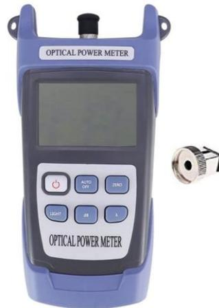
**Ilustración 52 Optical Power Meter**
