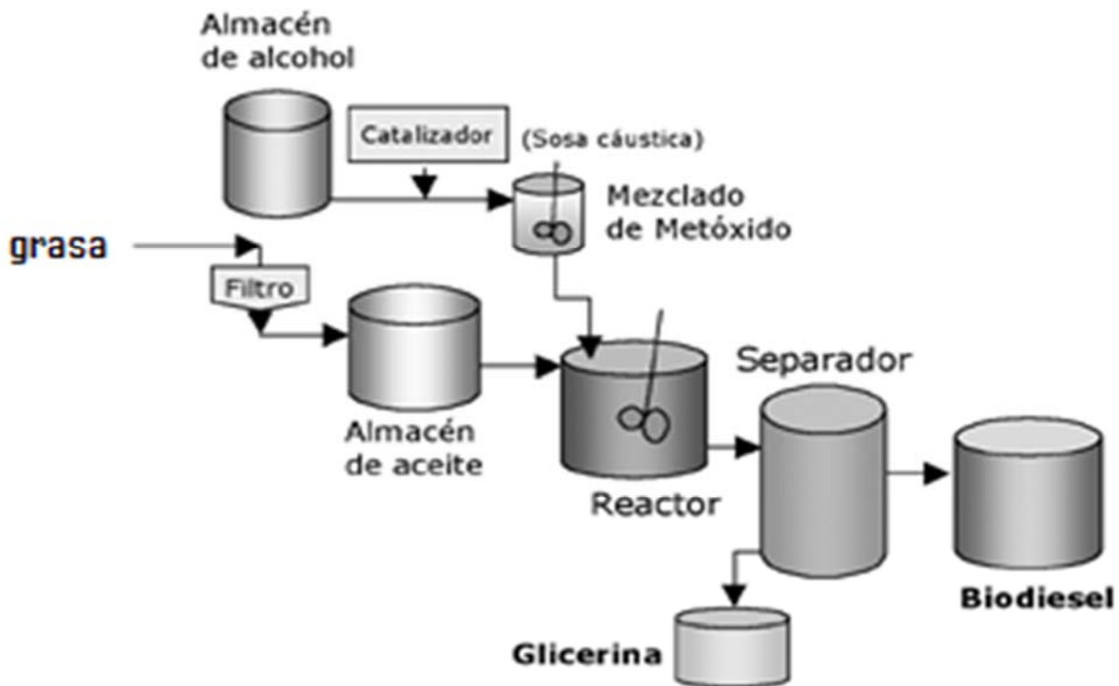
Imagen N° 21 Diagrama de obtención de Biodiesel, método mas empleado
