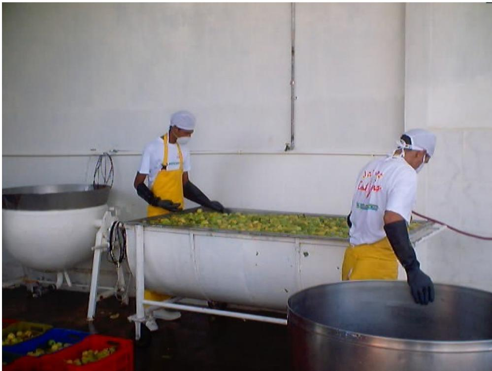
**Despulpado:** En este paso dos operarios toman una tina y la echan en la boquilla de la despulpadora, con la mano un operario empuja la fruta para que esta pase por la malla que va a separar la pulpa de la semilla, estos van cayendo en unas tinas plásticas desinfectadas para verter tanto la pulpa como la semilla en la marmita donde se ara el proceso de escaldado.
