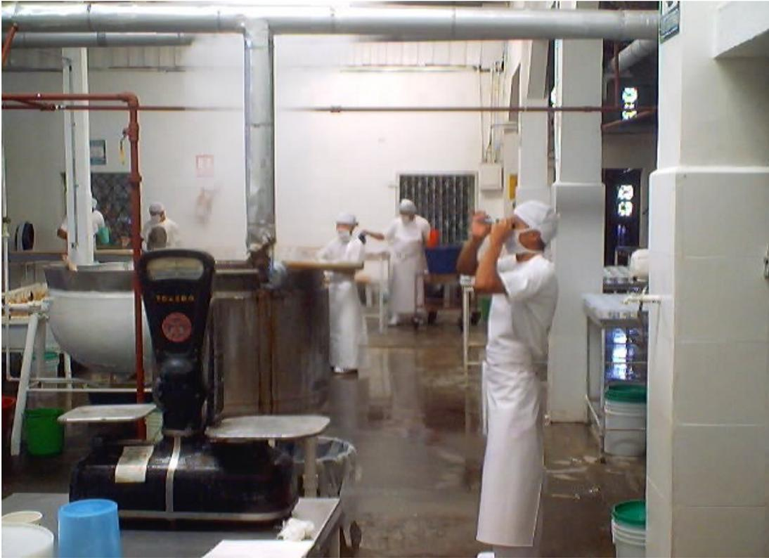
**Filtrado(tela):** A la salida de la boquilla de la marmita se coloca una tina y encima de esta una tela que sirve como filtro para no dejar pasar ningún elemento extraño como residuo del azúcar, se hace con el objetivo de detener el paso de cualquier partícula que vaya a causar mala impresión en el producto.
