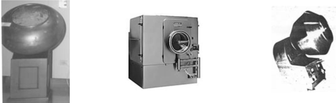
**Figura 1.** Diferentes tipos de tulipas de recubrimiento.
