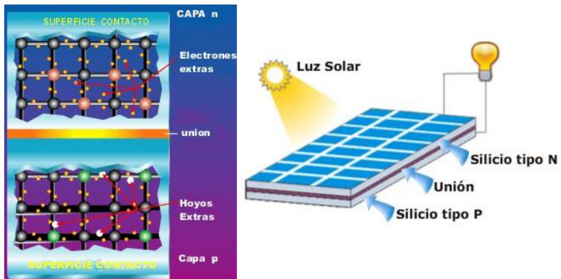
Figura N° 15 Representación esquemática de la celda fotovoltaica<sup>14</sup>
