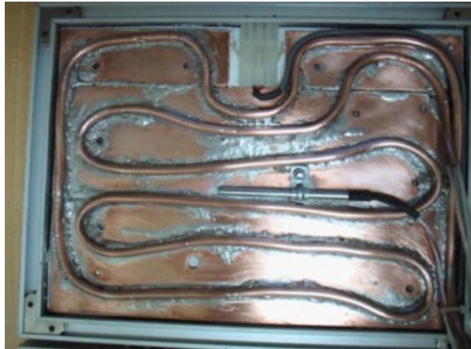
Este conjunto se ha impregnado de silicona para semiconductores cuya función es la de conseguir una buena transferencia térmica entre la cara posterior del panel fotovoltaico y la pletina del absorbedor.
