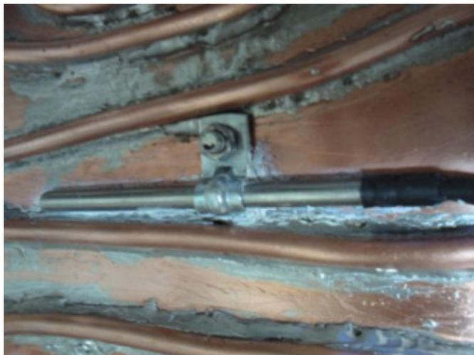
En la entrada y salida del absorbedor se han instalado dos trozos de tubo de vinilo por donde circulará el líquido refrigerante, en los ensayos se ha utilizado agua.
