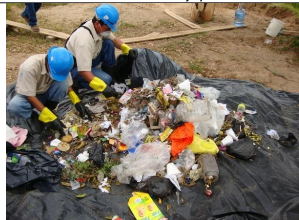
Figura 21. Caracterización de desechos en el relleno sanitario de la C.H. 5 de Noviembre.
