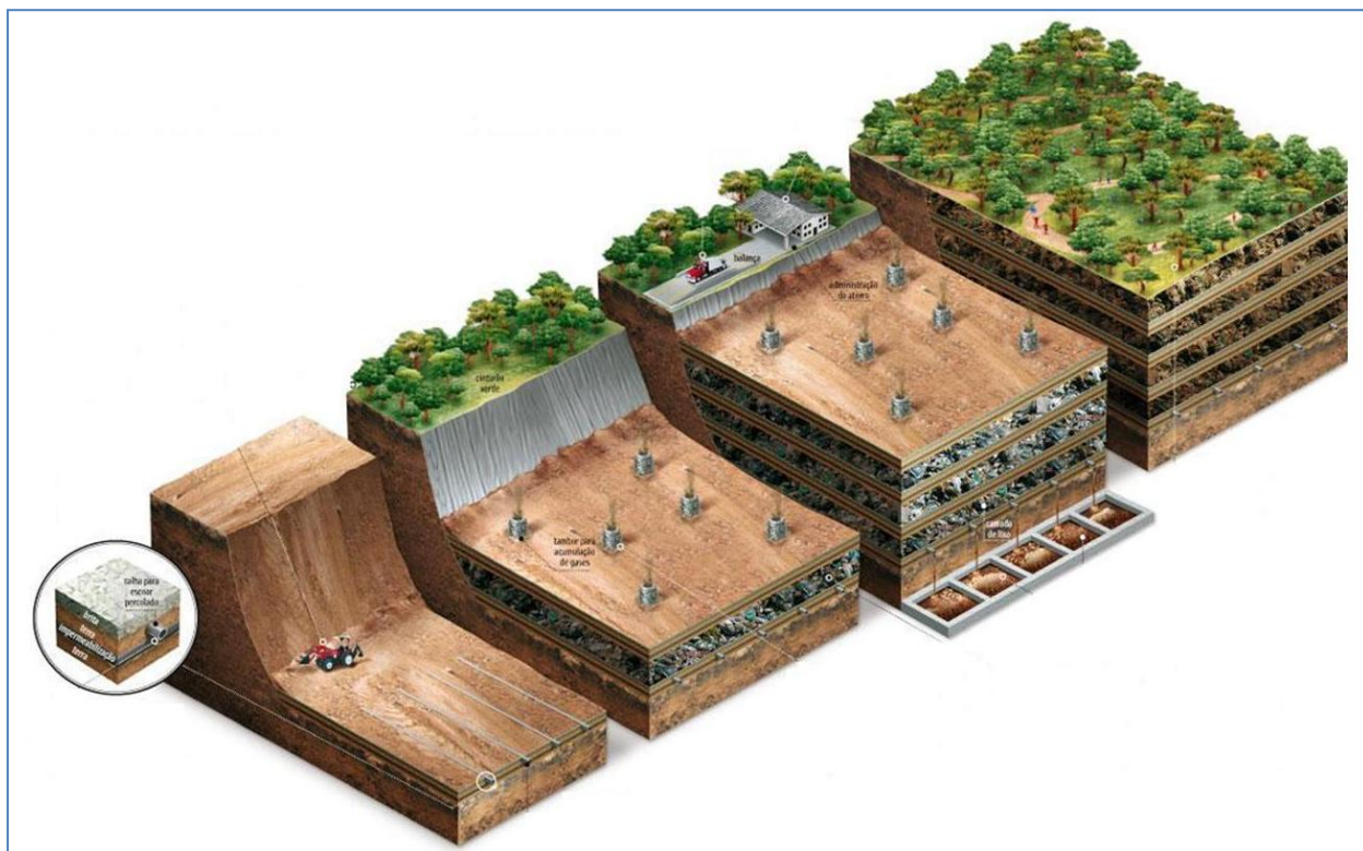
Figura 3. Desarrollo esquemático de la vida de un relleno sanitario.
